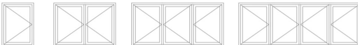
Les profilés du système HP/PE permettent des ouvertures battantes à 1, 2, 3 et 4 vantaux. Ils permettent également l'application de panneaux à lattes, de lattes fixes avec et sans trous et de lattes réglables.
